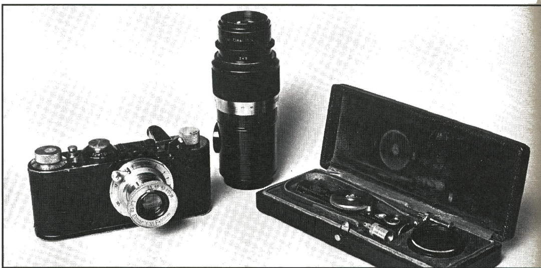
Dette udstyr er ca. 12.000 kr. værd blandt samlere. Prisen skyldes, at Leica I »C« kameraet fra 1930-31 er en overgangsmodel mellem kameraer med fast og med udskiftelig objektiv. De to specialtilpassede objektiver er en 50 mm/f:3,5 og en 135mm/f:4,5. I æsken til højre ligger den tilhørende afstandsmåler og trådudløser.
